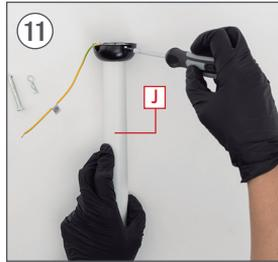
11 Ziehen Sie die beiden Schrauben an der Neigungshalterung mit dem Schraubendreher fest.
