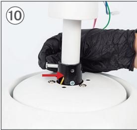
Sobald die Stange eingesetzt ist, platzieren Sie den Stift des Teils I/J so dass es mit dem Loch in der Stange übereinstimmt.
