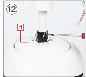
Dann ersetzen Sie die Schrauben auf dem Teil H sodass die Stange vollständig gesichert ist.
