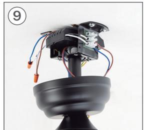
Verbinden Sie die restlichen Drähte des Teils mit Hilfe eines flachen Schraubendrehers B zu denen des Lüfters, wobei jeder mit dem Streifen und dem entsprechenden Kabel verbunden wird.
