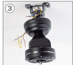
Setzen Sie die Kippstütze in den Schlitz des Teils ein **J** so dass es an der Decke befestigt ist. Denken Sie daran, die Kerbe wieder auf die schwarze Oberseite zu setzen, damit das Teil gut passt. Bevor Sie fortfahren, überprüfen Sie, ob der mittlere Rahmen sicher positioniert ist, damit er nicht herunterfällt.
