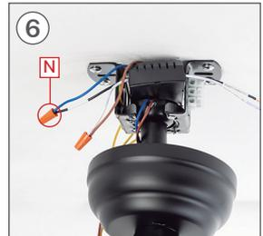
Verbinden Sie das PHASE (L) -Kabel Ihrer Installation mit dem PHASE Kabel des Teils B. Sobald die Verbindung hergestellt ist, platzieren Sie das Teil N Schrauben Sie es ein, bis es sicher ist.
