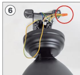
Schließen Sie das Erdungskabel des Teils an **I** die des Motors. Wenn Ihre Elektroinstallation aus einem eigenen Erdungskabel besteht, schließen Sie es zusätzlich an die Kabel des Teils an **I** und der Motor.
